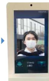
人が近付くと「センサー」が感知して「カメラモード」に切り替わります
